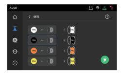
3. 选中左边的框,然后从右边选择需要打印的耗材通道。可重复选择通道。如果没有耗材与文件中指定的颜色匹配,您可以将指定的耗材放置在IFS通道中,或者选择具有相同属性和接近颜色匹配耗材。配置材料通道后,可点击打印。如果打印切片时选择的材料和IFS上的耗材种类不一致,则无法选择该耗材打印。
